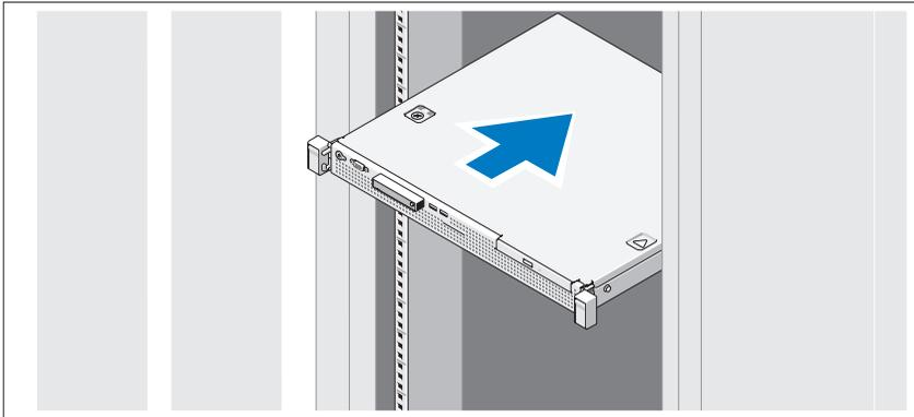
안전 지침 및 시스템과 함께 제공되는 랙 설치 지침에 따라 레일을 조립하고 시스템을 랙에 설치합니다.
