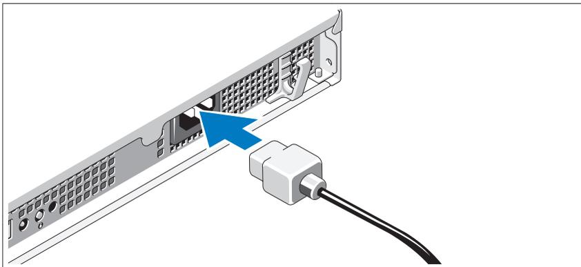
Hubungkan kabel daya sistem ke sistem dan, jika menggunakan monitor, hubungkan kabel daya monitor ke monitor.
