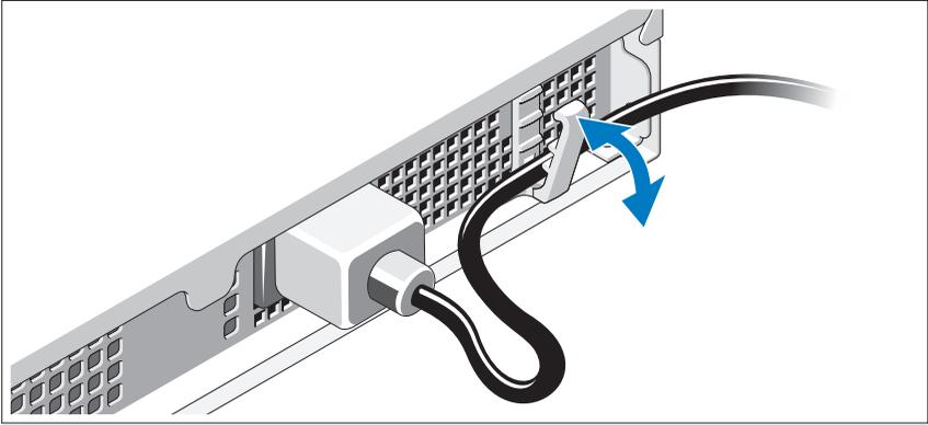
그림과 같이 시스템 전원 케이블을 구부려서 고정 클립으로 케이블을 고정합니다.
