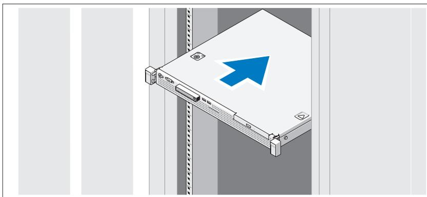
レールの組み立てとラックへのシステムの取り付けの際は、システムに付属しているマニュアルの安全にお使いいただくための注意事項およびラックへの取り付け手順に従ってください。
