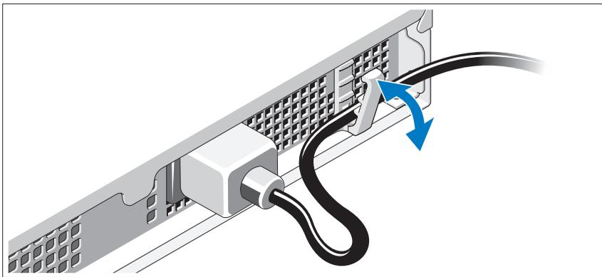
如图所示，将系统电源电缆弯曲图中的形状，并使用固定夹固定好电缆。将电源电缆的另一端插入接地的电源插座或单独的电源，如不间断电源设备 (UPS) 或配电装置 (PDU)。
