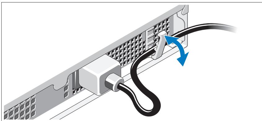
システムの電源ケーブルを図のように曲げ、固定クリップで固定します。
